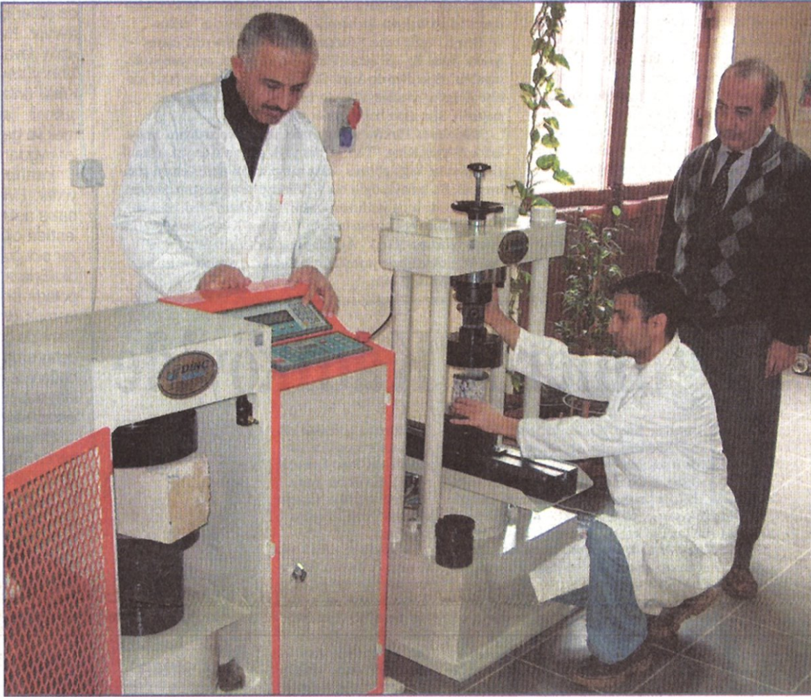
Beton ve Zemin Laboratuvarı'nda yeni inşa edilen ve mevcut binaların beton analizleri yapılıyor
